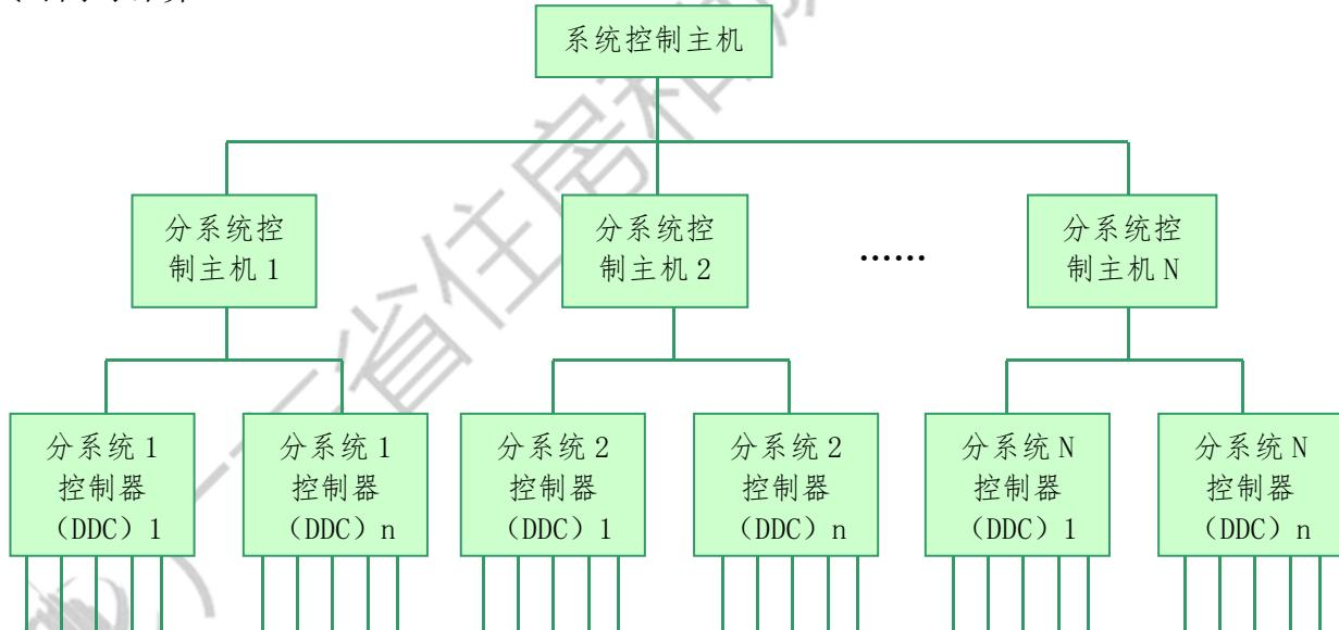
2. 系统设计结构型式如下图示意的建筑设备自动化系统工程，只能计算全系统调试。
